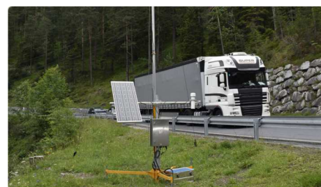
Nach den Erkundungsbohrungen © Paschinger geht es am Fernpass mit der Messung der Windsituation im geplanten Portalbereich weiter.
